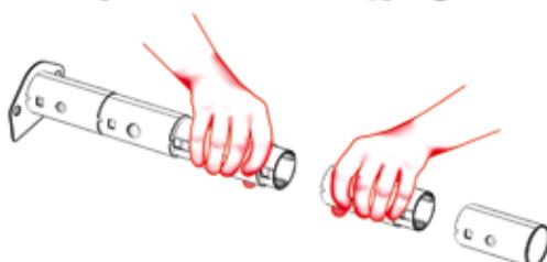
درهنگام مونتاژ لوله آب پخش کن حتما دقت فرمایید که مطابق شکل زیر خارهای موجود در لوله ها رو بروی هم قرار بگیرند .
