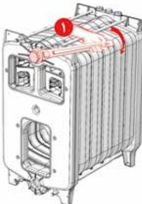
۱۳ - درب های بالا و پائین و دریچه بازدید شعله را به روش نشان داده شده روی دیگ موتتاژ نمایید. (به یاد داشته باشید که قبل از نصب درب نخ نسوز را در شیار درب نصب نمایید)
