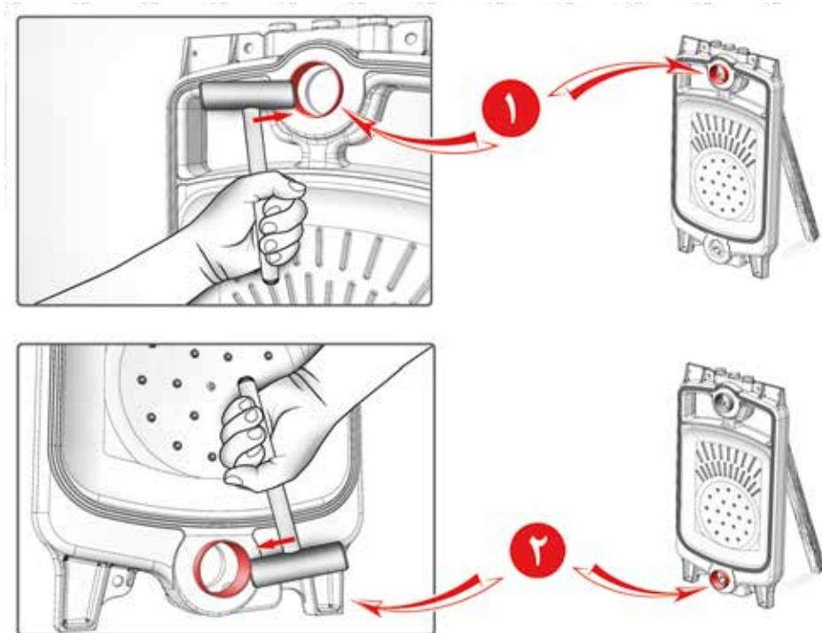
٥ - در صورت عدم استفاده از خمیر دیگ موجود در جعبه تحویلی از کارخانه ، روی شیارهای ریخته گری شده پره عقب دیگ چسب بمالید و سپس نخ نسوز را با چکش لاستیکی در شیار پره عقب جای گذاری نمائید .
